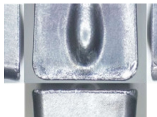
Сильный износ и частичное выкрашивание режущей кромки
