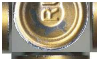
Сильное выкрашивание режущей кромки
