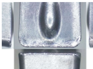
Сильный износ и частичное выкрашивание режущей кромки
